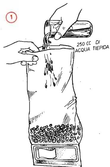
Fig. 1 - Dentro il sacco di plastica, ben aperto nella parte superiore, si introducono 250 grammi di acqua calda tramite l'apposito misurino (sacco di plastica piccolo) contenuto nel kit. L'acqua versata sopra la sostanza granulare deve trovarsi ad una temperatura tale da essere facilmente tollerata dalle mani dell'operatore.
